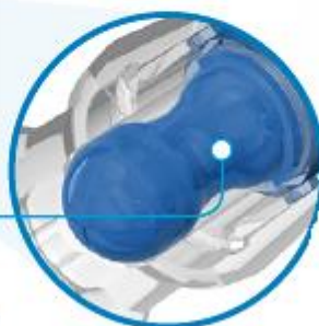
A szelep állása visszaáramlást provokáló helyzetben
